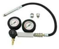
EQUIPAMENTO P/MEDIR VAZAO CILINDRO DO MOTOR (MOTO)
