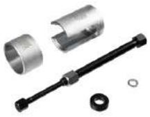
EXTRATOR INSTALADOR DA BUCHA SUSP.TRAS.CORSA
