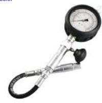
MEDIDOR DE COMPRESSAO P/ MOTOR DIESEL
