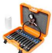
TESTE PRESSAO/VAZAO BOMBA COMBUSTIVEL (11 MANG)
