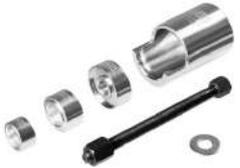
EXTRATOR E INSTALADOR BUCHA DIANT.BAND.PALIO
